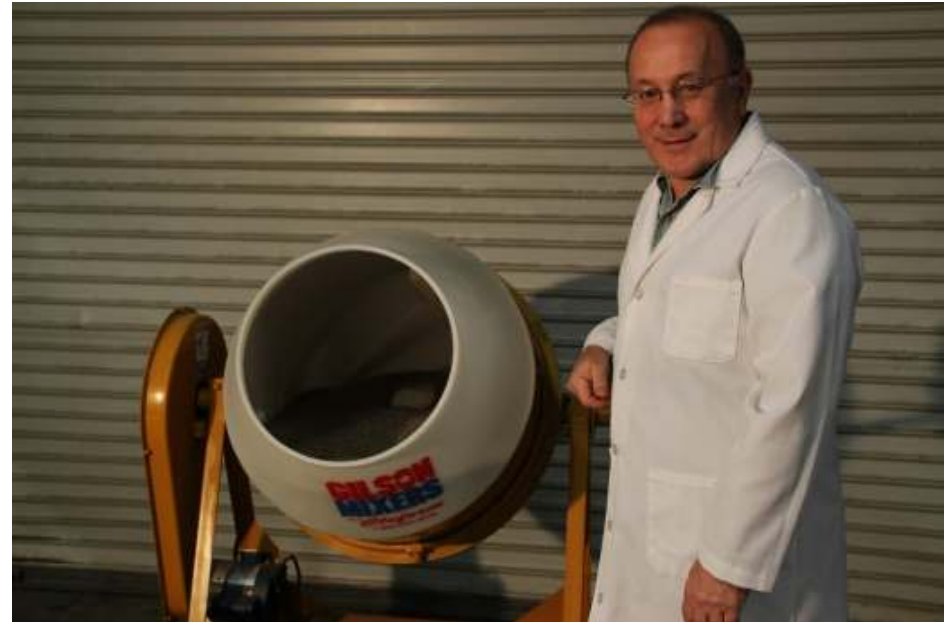
Im Probenmischer werden die Umweltproben mit schwach radioaktiven Referenzmaterialien gemischt.
