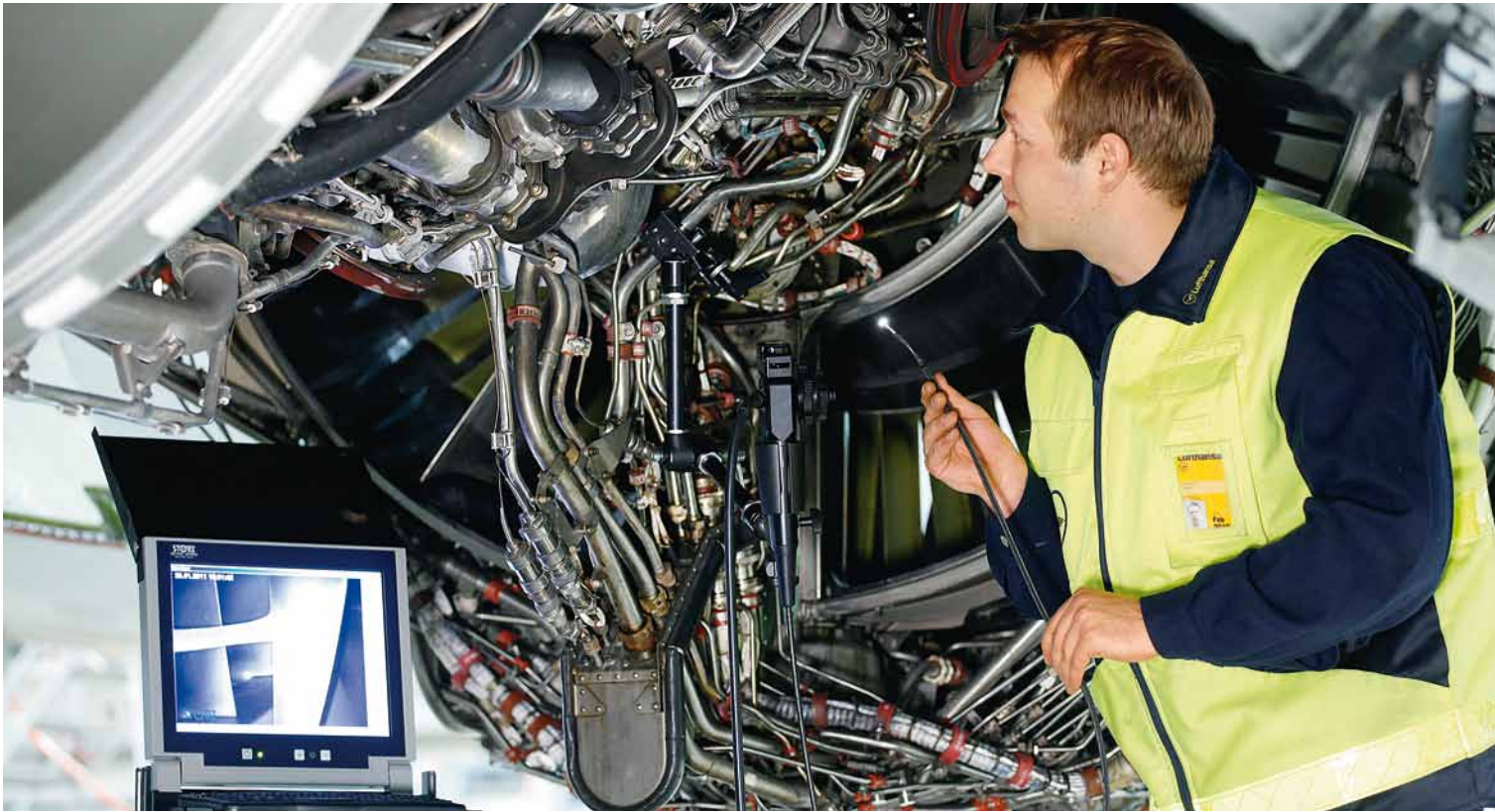
Im Testbetrieb mit Biokraftstoffen werden die Triebwerke auf Wartungsintensität und Lebensdauer untersucht.
